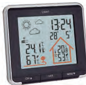
ESTACIÓ METEOROLÒGICA SENSE FILS 9703214 Previsió meteorològica per símbols. (Basats en canvis d'humitat). Temperatura i humitat interior i exterior amb sensor remot. Admet fins a 3 sensors remots. Abast fins a 60 m (en camp lliure). Rang de temperatura: Interior 0+50°C. Exterior -30+70°C. Rang d'humitat: Interior/Exterior 20-95% HR. Memòria màxima-mínima. Rellocte i calendari. Pantalla amb llum. Suport per a sobretaula i per fixar a paret. Alimentació 3 piles 1,5V AAA (no incloses).
